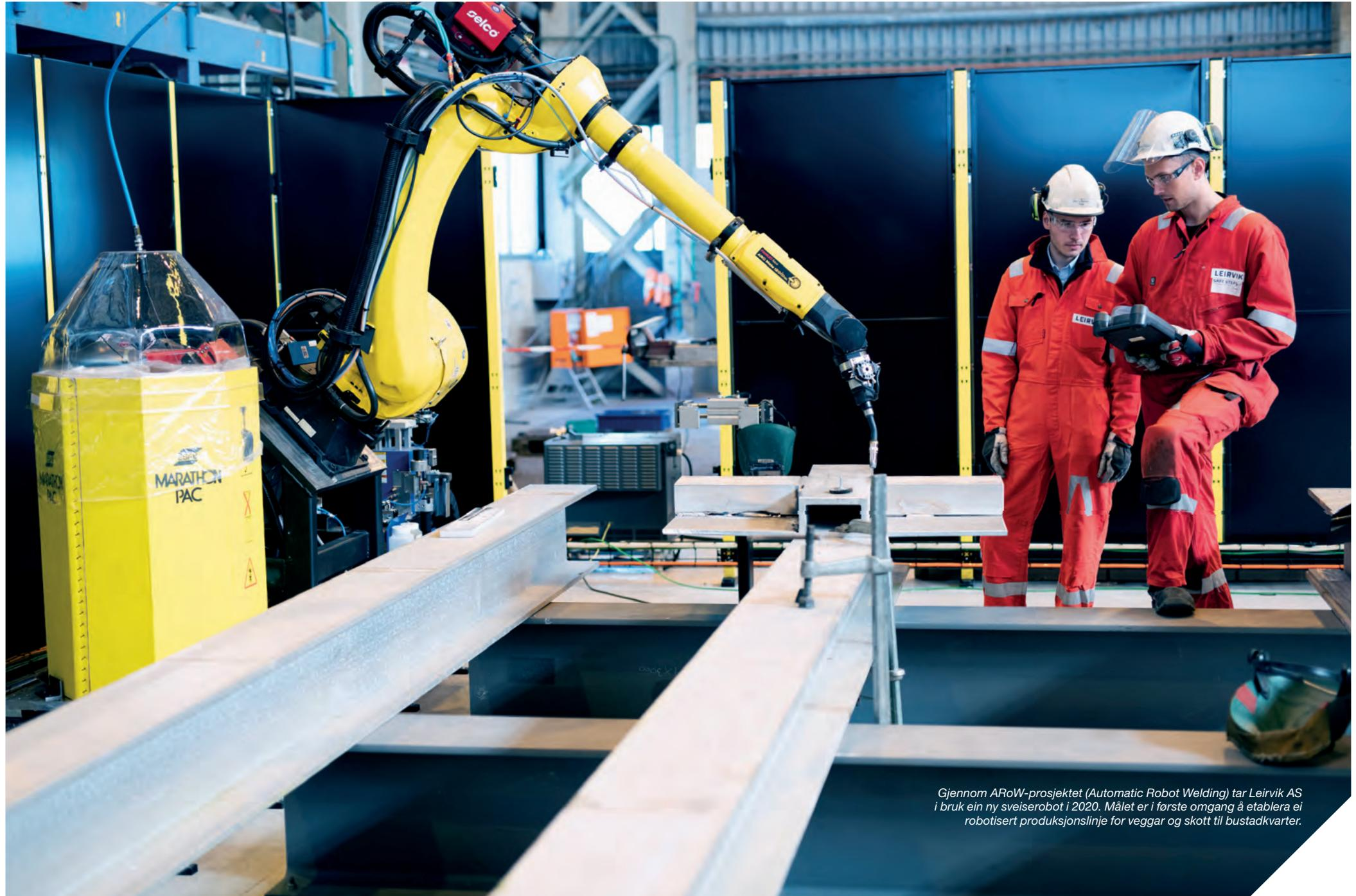
Gjennom ARoW-prosjektet (Automatic Robot Welding) tar Leirvik AS i bruk ein ny sveiserobot i 2020. Målet er i første omgang å etablere ei robotisert produksjonslinje for veggar og skott til bustadkvarter.
